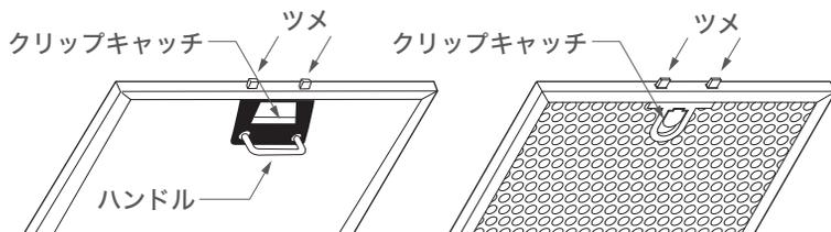
クリップキャッチを動かしてツメを前後させ、本体と着脱するタイプのフィルター。
