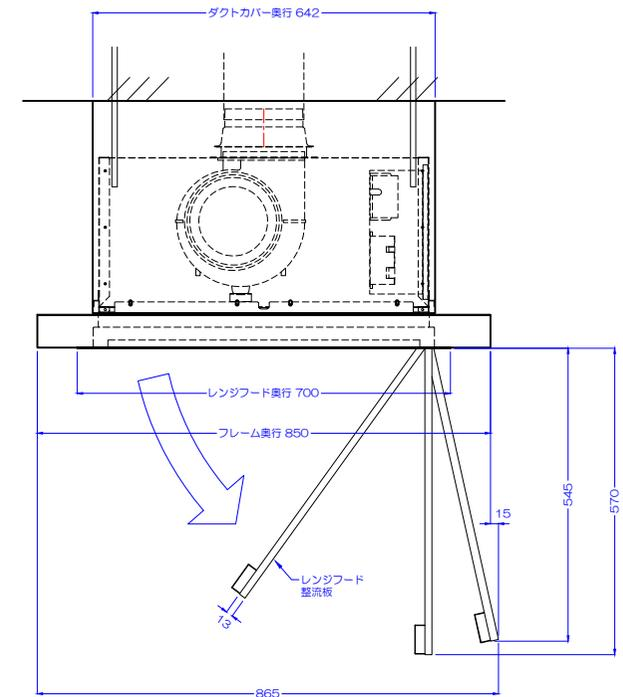
※1 フード吊りボルト突出し長さ = フード取付高さ - 300mm
